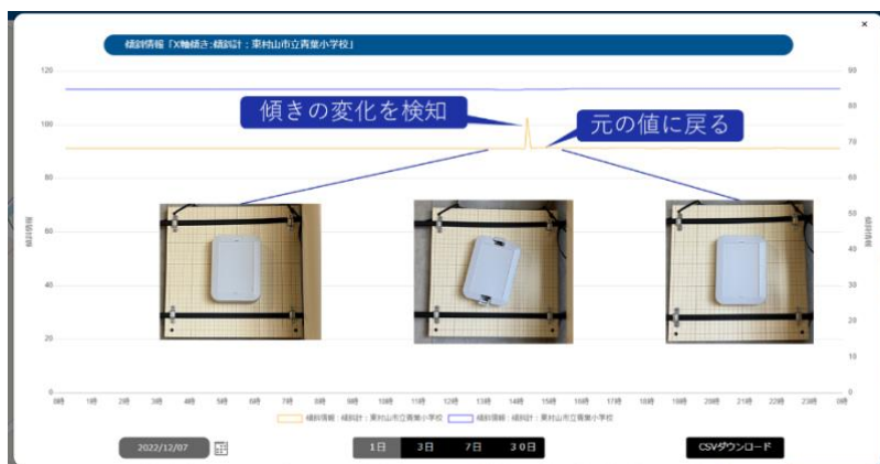
東村山市都市 OS ダッシュボード画面（青葉小学校） 傾斜計データ表示の例
