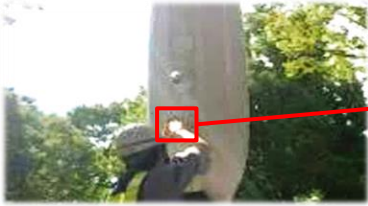
センサー固定ネジの確認
