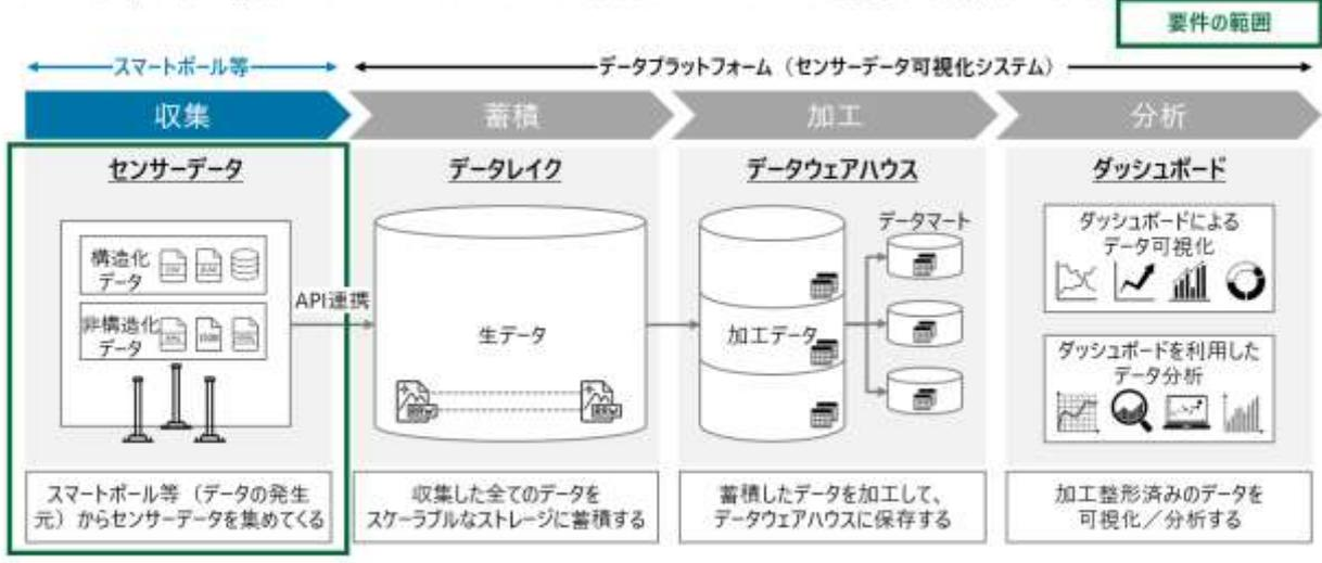
本資料では、スマートポール等で収集したセンサーデータを、センサーデータ可視化システムに連携するためにスマートポール等が具備すべき要件の詳細を示す
