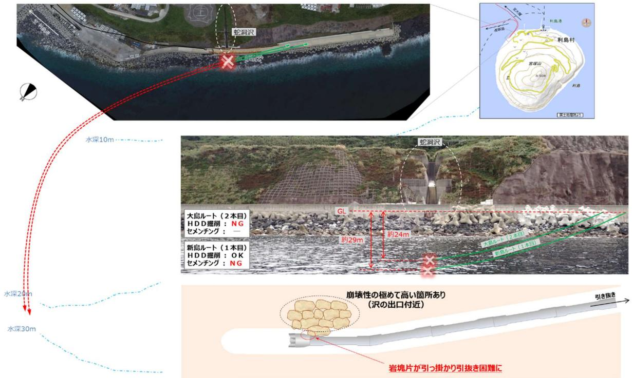
図 4.2.2 令和元年度 HDD 工事 (説明図は当時の想定)
