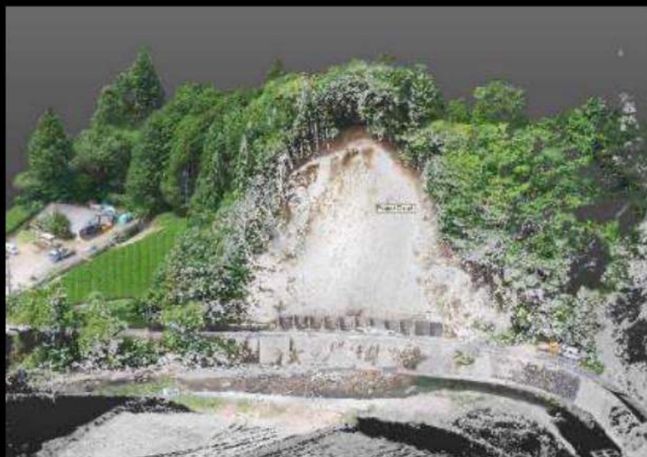
被災後の3次元点群データ
