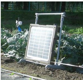
太陽光を電源とするWi-Fiアクセスポイント
