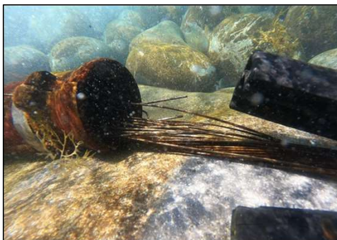
波浪によるケーブル断線
